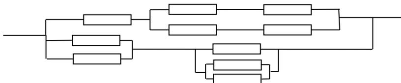
17. Техническая система состоит из десяти элементов. Структурная схема надежности системы изображена на рис.1. Вероятности безотказной работы элементов одинаковые и равны 0,95.
